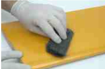
ORACOVER® kann mit "000" Stahlwolle aufgeraut werden.
